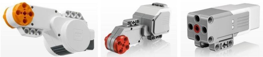
сервомотор EV3    средний сервомотор EV3    сервомотор NXT
