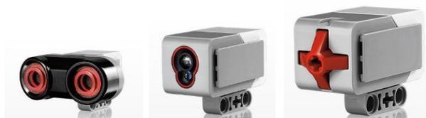
Датчик касания    Ультразвуковой датчик    Датчик цвета
